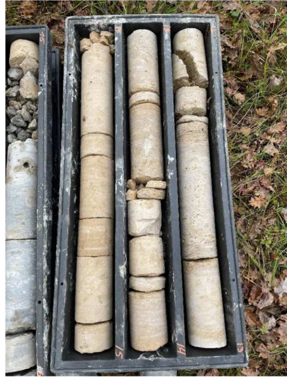
Sondage carotté de 12 à 15 mètres de profondeur (gisement)
