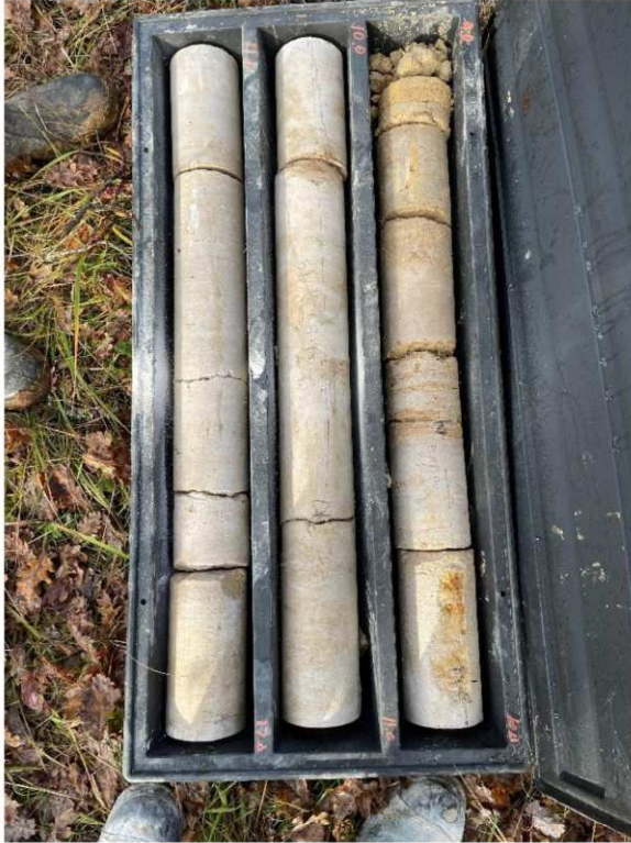
Sondage carotté de 9 à 12 mètres de profondeur (gisement)
